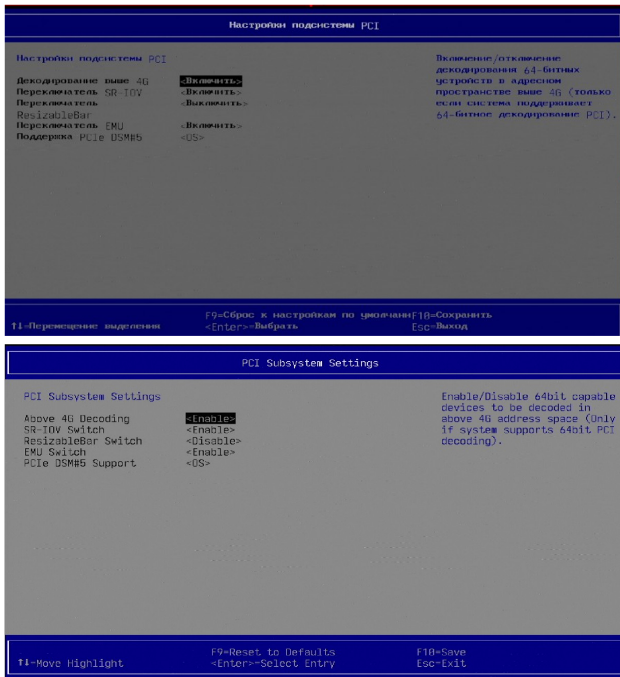
Рисунок 13 — Подраздел «Настройки подсистемы PCI (PCI Subsystem Settings)»
